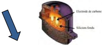
Figure 5 : Four à silic [3].
