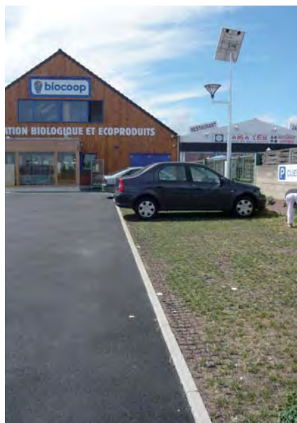
Exemple de parking de supermarché avec zone de stationnement en éco-green (alvéole plastique)
